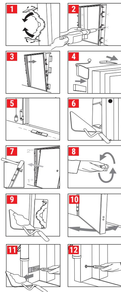
Consejo práctico para el montaje de una puerta de seguridad con obra: emplee estopa y escayola para una fijación más sólida y deje fraguar el material antes de realizar cualquier actuación.
