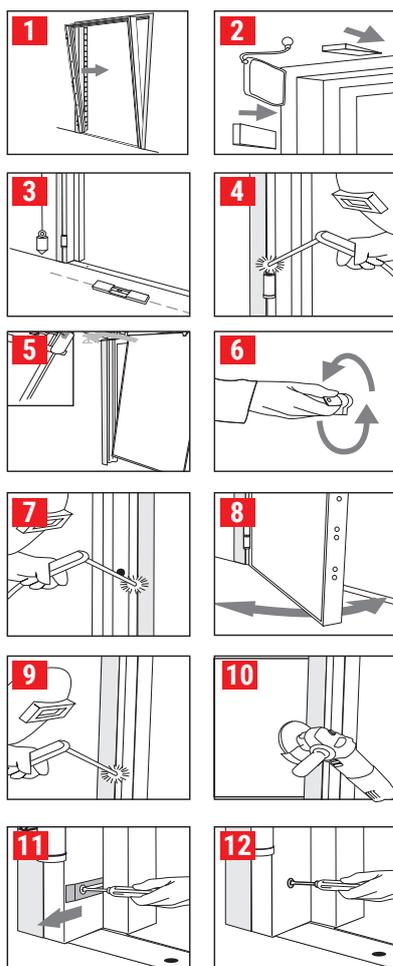
Altere los puntos de soldadura para no deformar el marco.
